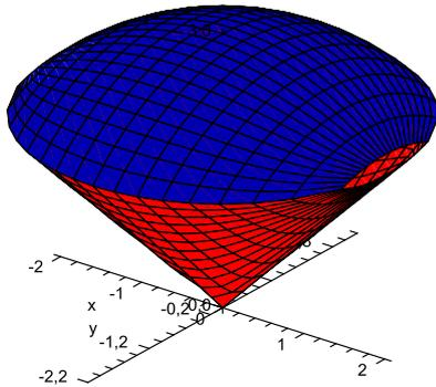
La surface sphérique (en bleu) est définie par l'équation  $z = \sqrt{9 - x^2 - y^2}$ , la surface du cône (en rouge) est définie par  $z = \sqrt{x^2 + y^2}$ . On note par  $D$  la figure ci-dessus.
