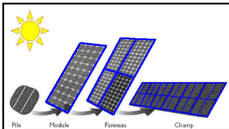
**Figure II.4 :** De la cellule au champ photovoltaïque.
