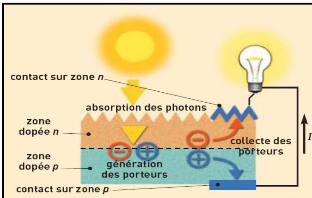
Figure I.2 : Principe de la conversion photovoltaïque.
