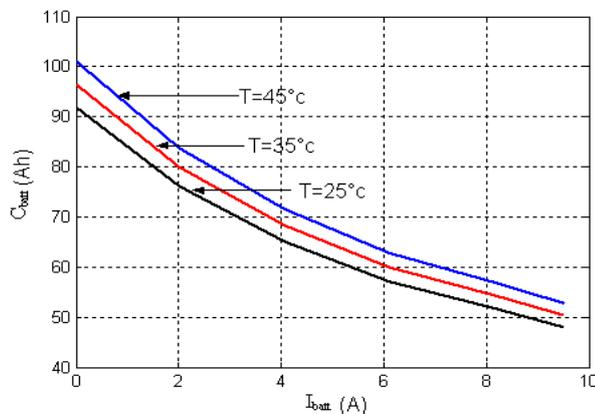
Figure III.6 : Influence de la température sur la capacité.
