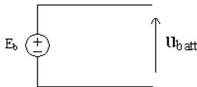
Figure III.2 : Modèle idéal batterie.
