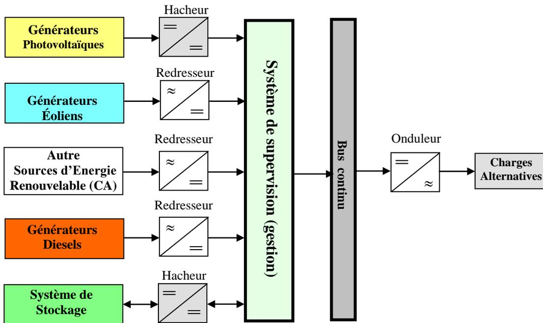
**Figure I.5 :** Configuration du système hybride à bus continu.
