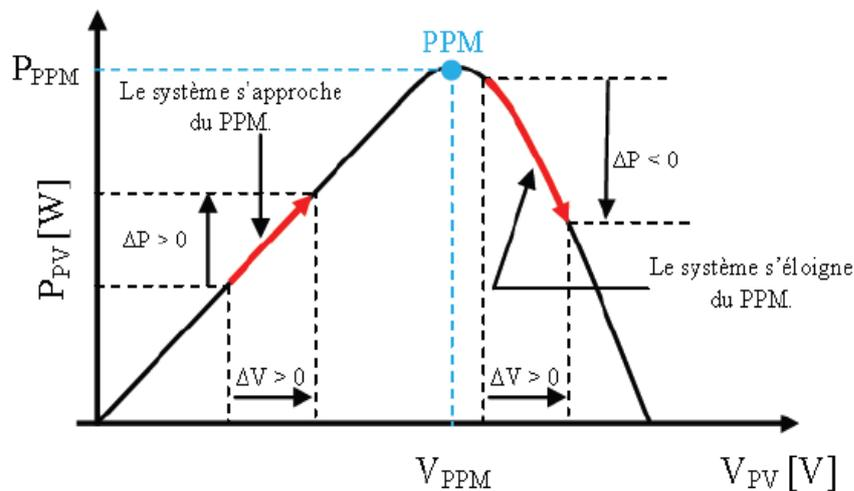
**Figure II.14 :** Caractéristique  $P_{pv}(V_{pv})$  et fonctionnement de la méthode Perturbation et Observation.
