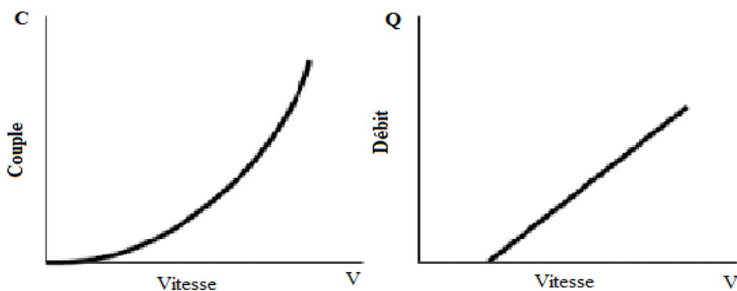
Figure IV.4 : Courbes du couple et du débit d'une pompe centrifuge.
