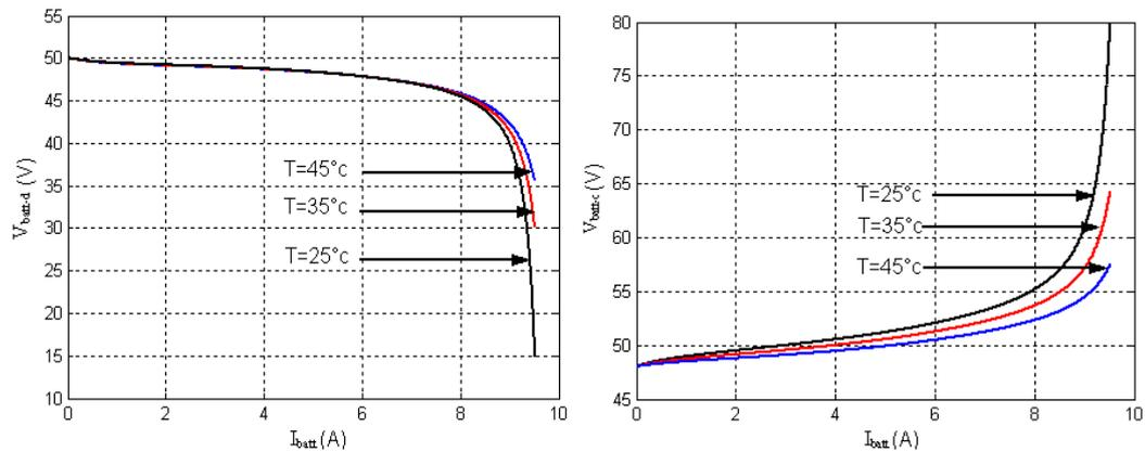
Figure III.9 : Influence de la température sur la tension de décharge et de charge.
