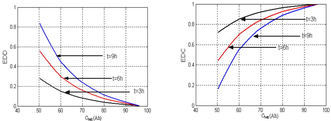
Figure III.10 : Influence du temps sur l'état de décharge et de charge.
