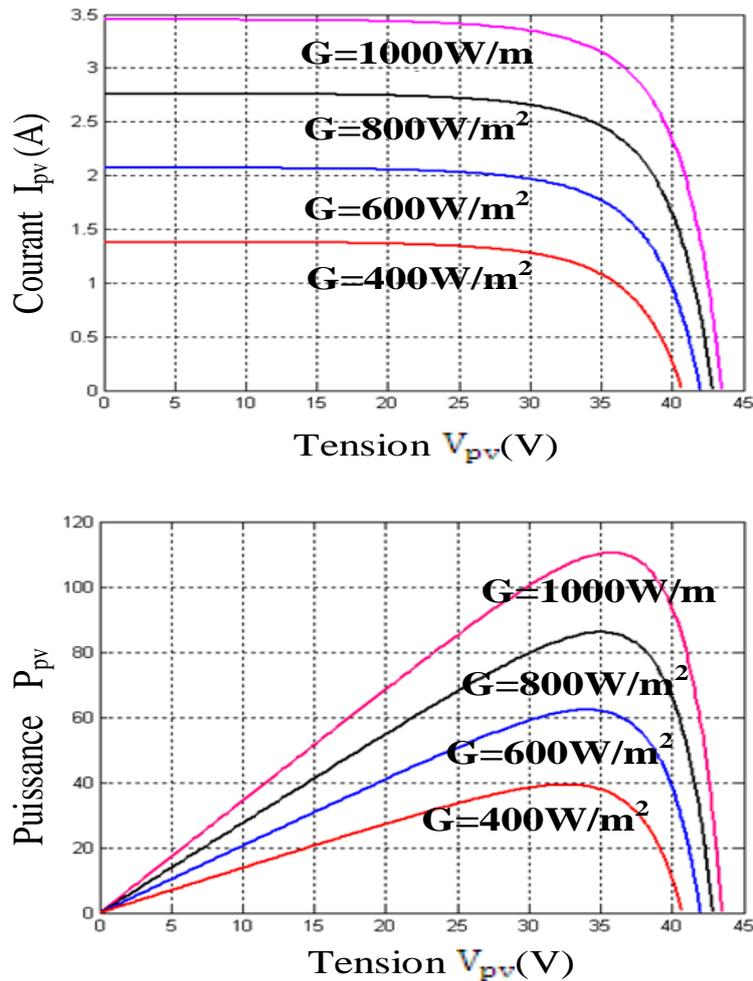
**Figure II.9 :** Caractéristique courant –tension et puissance –tension d’un module photovoltaïque pour différent niveau d’irradiation ( $G=400, 600, 800, 1000 \text{ W/m}^2$ ) et  $T_c=25 \text{ }^\circ\text{C}$ .
