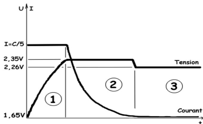
**Figure III.1:** Evolution de la tension et du courant avec le temps durant la charge d'un élément plomb acide.
