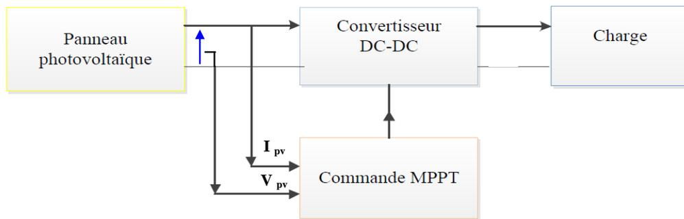
Figure II.13 : Système photovoltaïque avec convertisseur d'adaptation.
