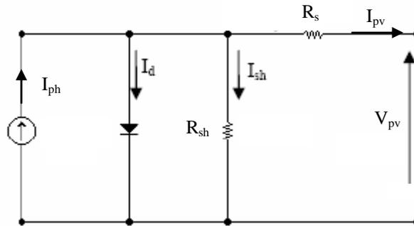
**Figure II.5** : Schéma électrique équivalent du modèle à une diode.
