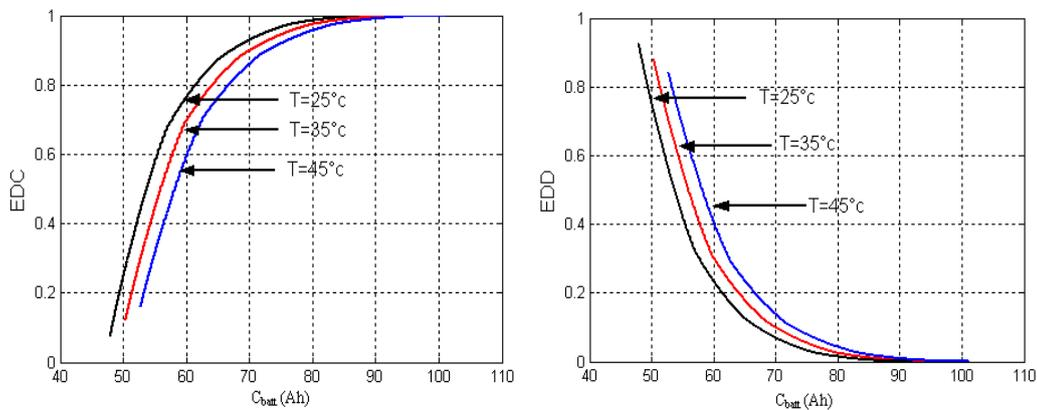
Figure III.8 : Influence de la température sur l'état de charge et de décharge.
