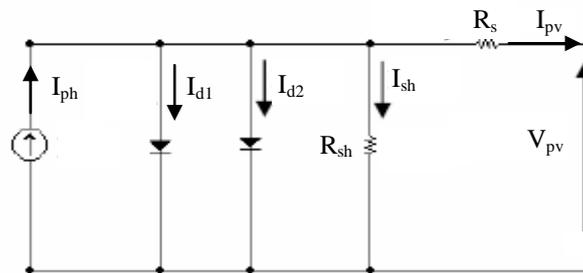
**Figure II.6 :** Schéma électrique équivalent du module photovoltaïque à deux diodes.
