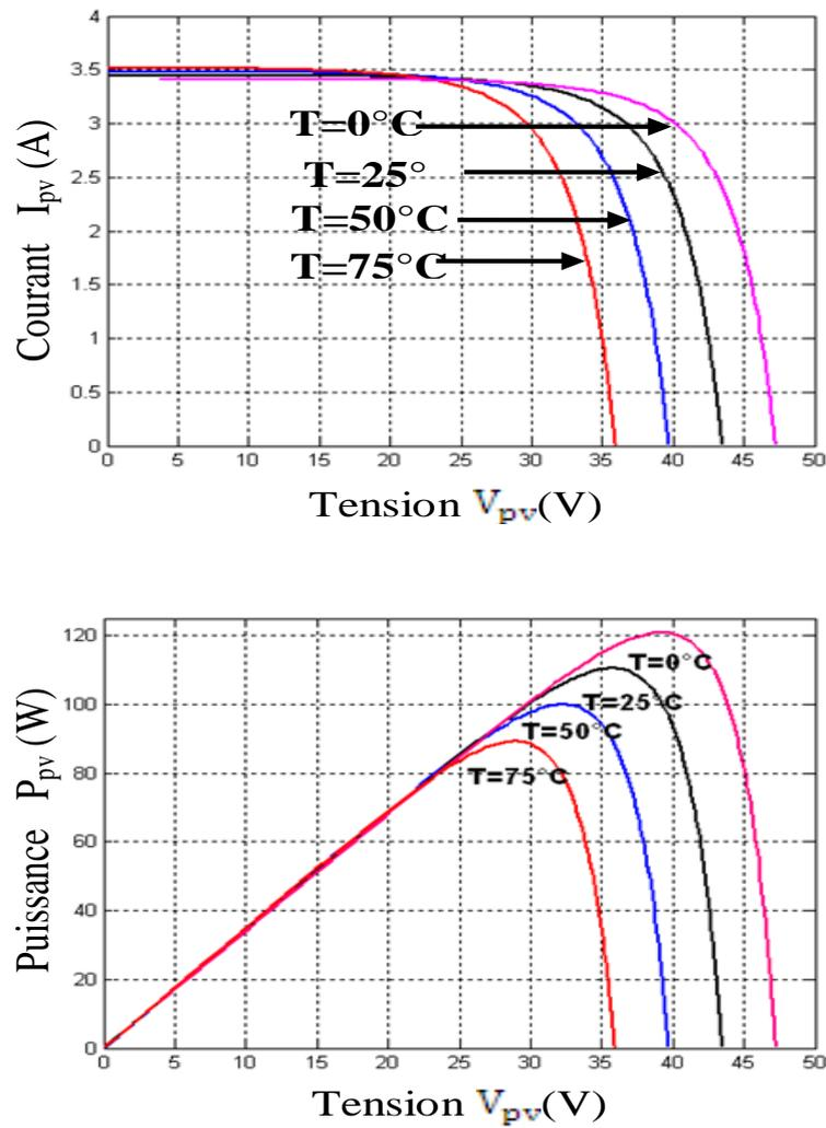
**Figure II.10 :** Caractéristique puissance –tension et courant –tension d’un module photovoltaïque pour une variation de température ( $T_c=0, 25, 50, 75^\circ\text{C}$ ) et  $G = 1000\text{W}/\text{m}^2$ .
