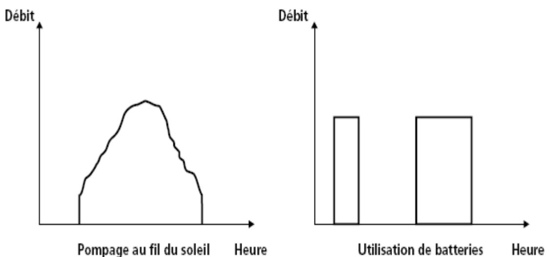
Figure IV.2 : Caractéristiques du débit pour le pompage au fil du soleil et avec batterie
