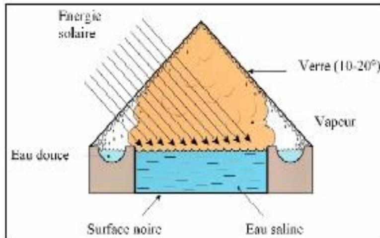
Figure IV.11 : Distillateur solaire direct.
