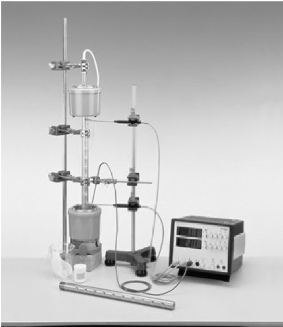
FIGURE 4.1 – Appareil servant à l'étude de la conductivité thermique des métaux.
