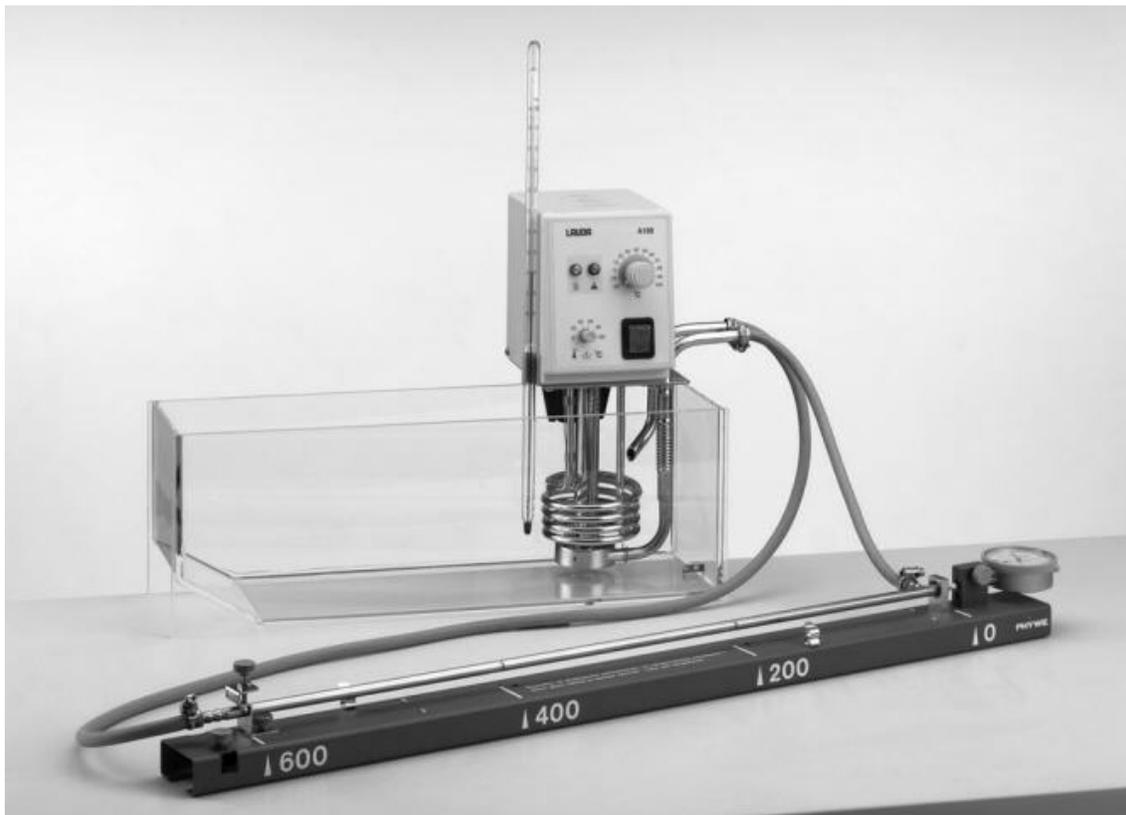
FIGURE 2.1 – Dispositif servant à l'étude de la dilatation linéaire des solides.
