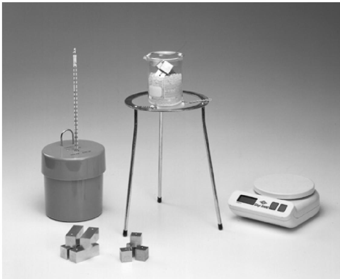
FIGURE 1.1 – Dispositif de détermination de la chaleur spécifique de solides ainsi que de la chaleur latente de fusion de la glace.
