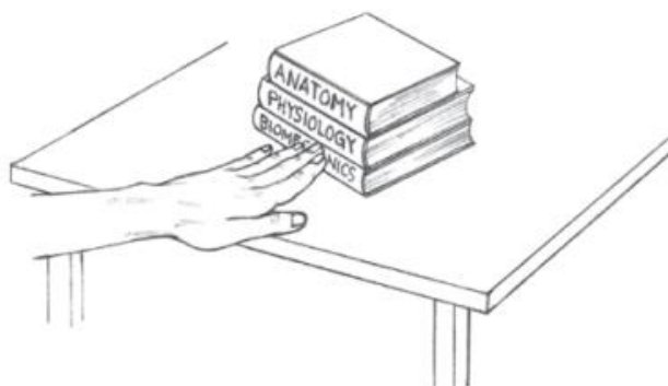
Figure 27: L'ajout de livres à la pile augmente le frottement statique entre le livre du bas et la table (McGinnis, 2013).
