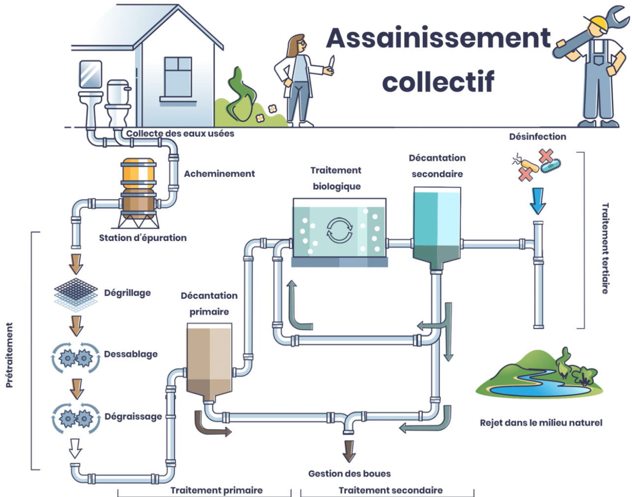
Figure 10: Etapes de traitement des eaux usées.
