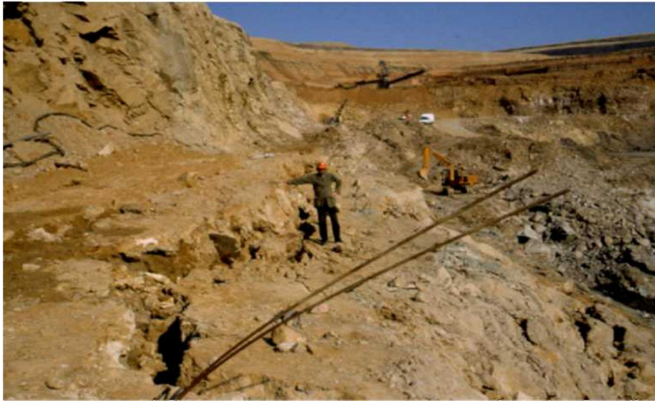
Figure 25. Glissement d'un compartiment rocheux découpé par deux failles majeures et d'anciens travaux miniers souterrains. Grande découverte de charbon de Carmaux.
