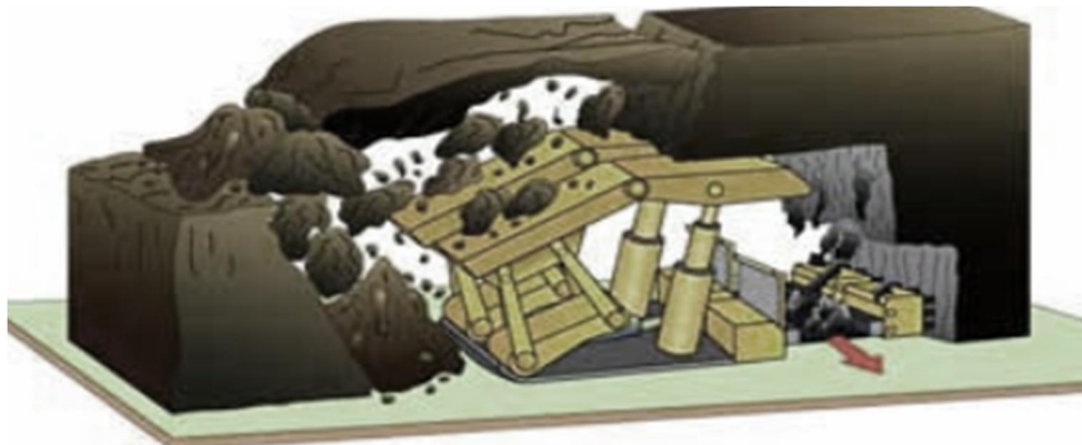
Figure 21. Schéma de principe d'exploitation par longues tailles.
