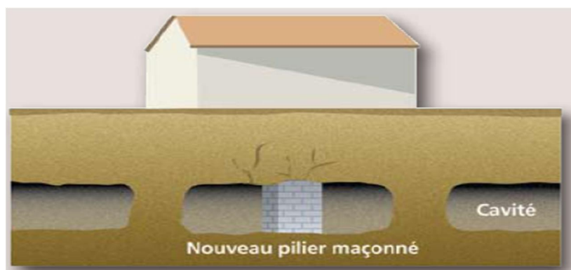
Figure 31. Schéma représentatif pour le renforcement du toit par piliers en maçonnerie
