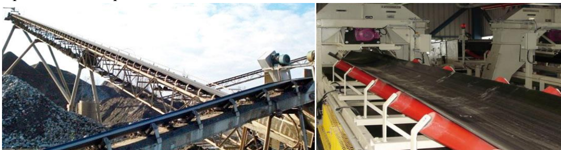
Figure II.5 Echantillonneur pour bandes transporteuse.
