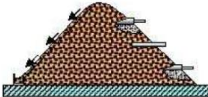
Figure II.1 Prélèvement d'échantillon de granulat sur le tas
