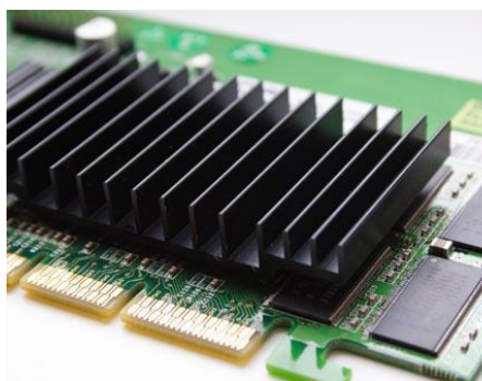
Figure I.07 Exemple d'ailette de refroidissement et de nid d'abeille pour augmenter la surface d'échange convectif (ELECTROLUBE)
