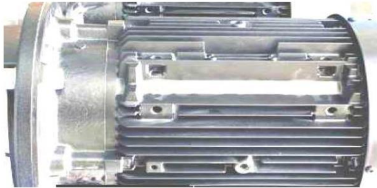
Figure I.21 Refroidissement externes par des ailettes
