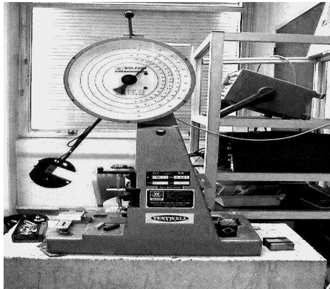
Figure 8 : Photo d'un mouton pendule Charpy.
