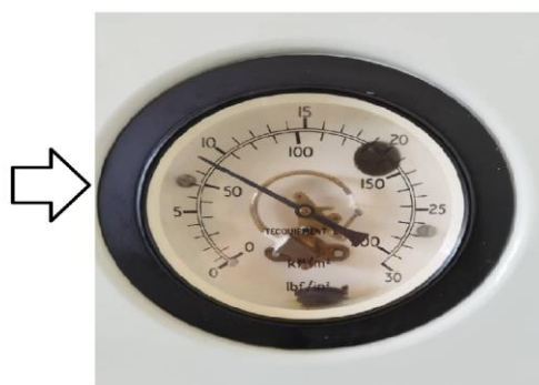
lire la pression sur le manomètre à bourdon
