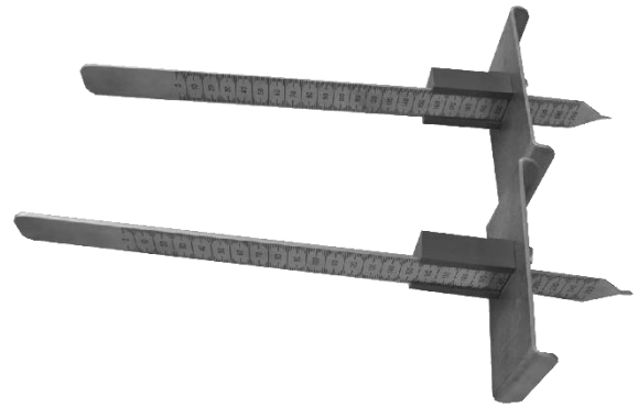
Figure IV.4 : Tube de niveau ou de profondeur
