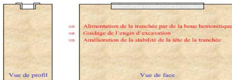
Fig. 2. 12: Exécution de murets-guides.
