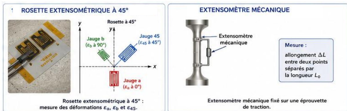
Fig. 4.17. Rosette extensométrique, extensomètre mécanique
