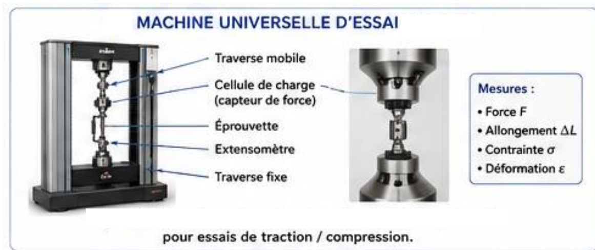
Fig. 4.20. Machine universelle d'essai (INSTRON? Zwick)
