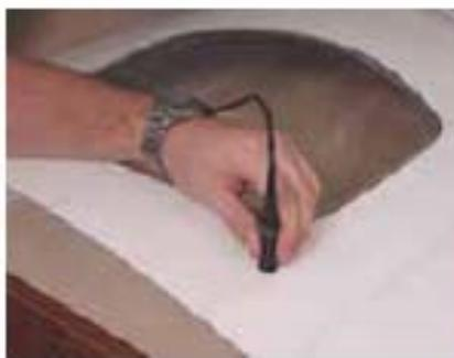
8 différentes épaisseurs de peinture sur un panneau d'aluminium (fuselage d'un avion).
