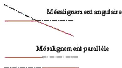
Pour un déalignement angulaire, on mesure un angle différent de  $180^\circ$  entre les deux axes, tandis que pour un déalignement parallèle, les deux axes ne se trouvent pas dans un même plan.
