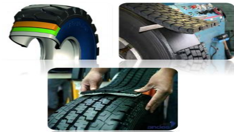
Figure IV.15. Réutilisation des pneus usagés par rechapage
