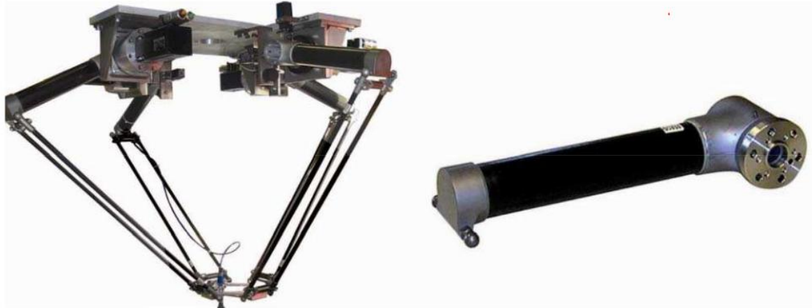
Le robot PAR4 et un bras d'origine (d'après documents LIRMM).
