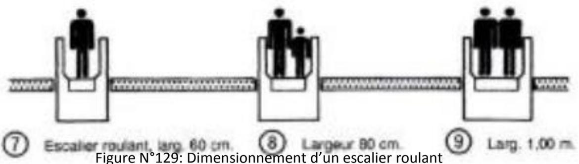
Figure N°129: Dimensionnement d'un escalier roulant
