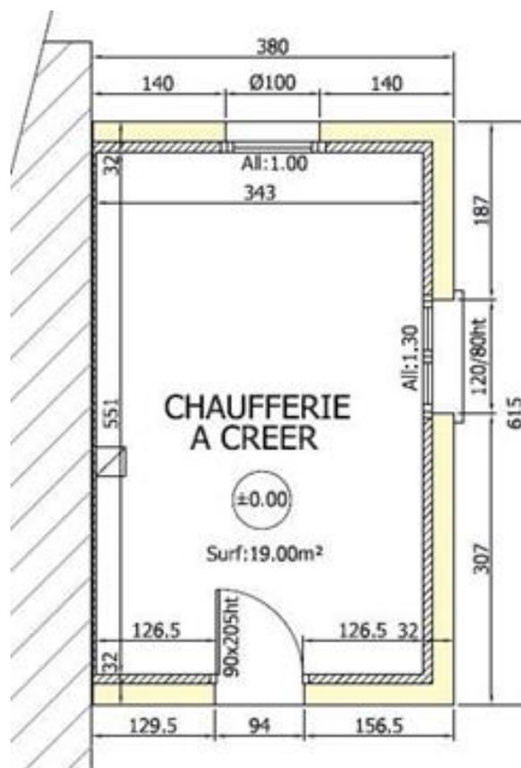
Figure N°76: Plan simple d'une chaufferie
