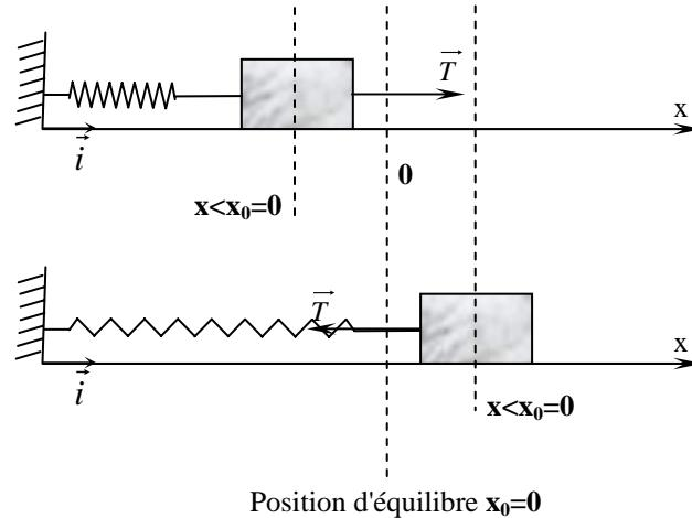
Supposant que la dérivée de l'énergie potentielle à  $x_0$  est nulle ( $\left. \frac{dE_p}{dx} \right|_{x=x_0} = 0$ ). Pour
