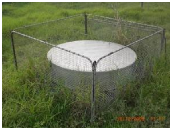
Figure 2-18. Photo montrant un bac d'évaporation ( exposeblog2010.over-blog.com ).
