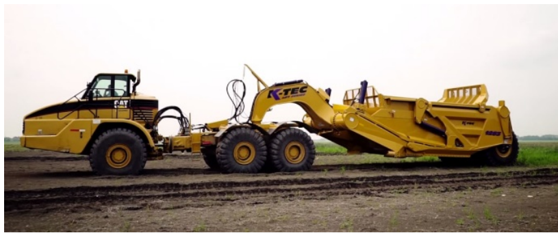
Photo 5. Racleurs pour excavation du déversoir du barrage.
