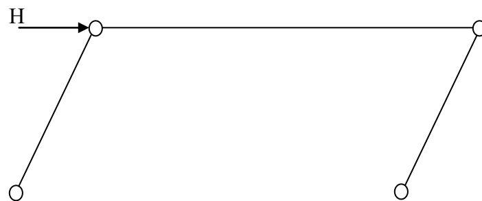
Figure 17 : Mécanisme de ruine pour cause de système hypostatique (ici les liaisons rigides poteaux poutres ont été supprimées)
