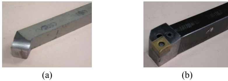
Fig. 3-5 Outils de coupe (a) en acier rapide supérieur (ARS), (b) a plaquette en carbure.
