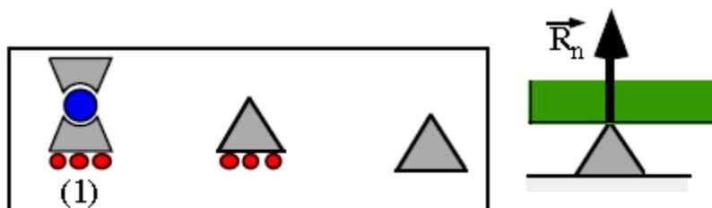
Cet appui permet 2 degrés de liberté : la translation, de la structure étudiée, par rapport à la surface d'appui, et la rotation autour du point d'application. C'est typiquement la situation que l'on rencontre lorsqu'on pose un objet sur un pivot.
