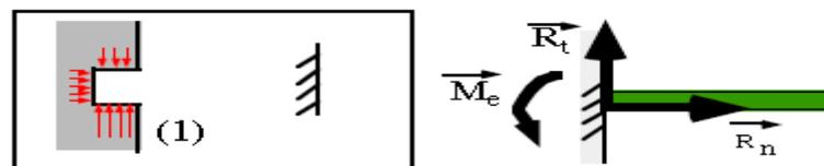
Cet appui ne permet aucun degré de liberté. Cette réaction se décompose en trois éléments qui sont, la réaction normale à la surface d'appui, la réaction parallèle à cette surface et le moment d'encastrement (voir figure).
