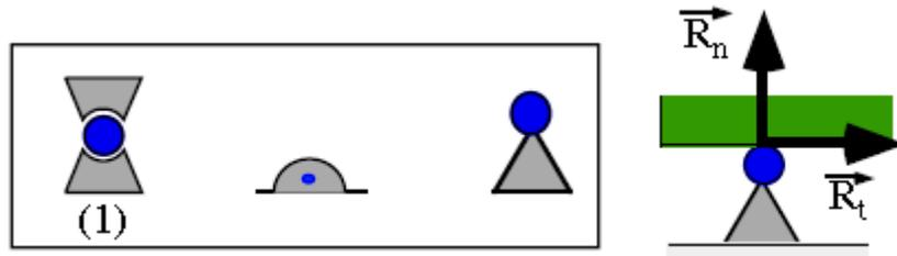
Cet appui permet 1 degré de liberté, la rotation autour du point d'application. Il est commode de décomposer cette réaction en une composante normale à la surface d'appui et une composante parallèle à cette surface.
