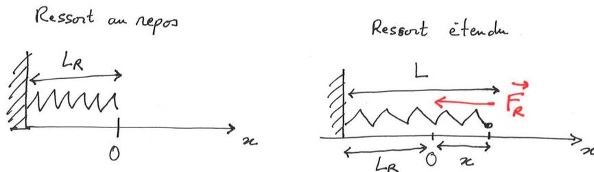
Figure 5: Déformation et force exercée par un ressort.
