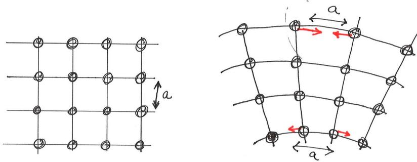
Figure 4: Matière solide cristalline et déformation de ce cristal
