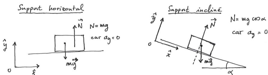
Figure 6: Réaction normale d'un support horizontal ou incliné sur un objet posé dessus.
