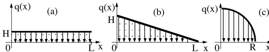
**Figure IV.7** On décrit ici les trois géométries de bases servant à modéliser les formes complexes. Elles sont décrites par la fonction  $q(x)$  (en trait gras sur la figure)
