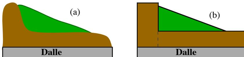
**Figure IV.6** Le schéma (a) décrit une dalle supportant un talus de terre avec sa végétation tel qu'on peut le trouver dans la réalité. Le schéma (b) indique le modèle simplifié servant au calcul du centre de masse.
