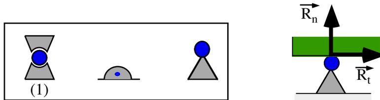
**Figure IV.9** Dans l'encadré figure différents symboles. Comme pour la figure IV.8 le symbole (1) explicite les degrés de liberté permis. Le dernier schéma montre la réaction.
