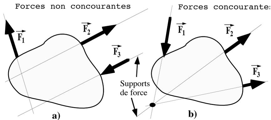
**Figure III.1** a) Système de forces non-concourantes. Dans ce cas, les forces  $\vec{F}_1$  et  $\vec{F}_2$  sont concourantes, par contre  $\vec{F}_3$  ne l'est pas. Elle a tendance à faire tourner l'objet. b) Toutes les forces sont concourantes.
