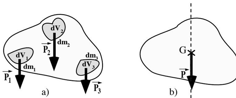
**Figure IV.4** Par définition, le centre de masse, de l'objet représenté ici, est l'endroit où la résultante de tous les  $\vec{P}_i$  ne provoque pas sa rotation. Cette définition définit en fait un axe vertical et pas seulement un point.
