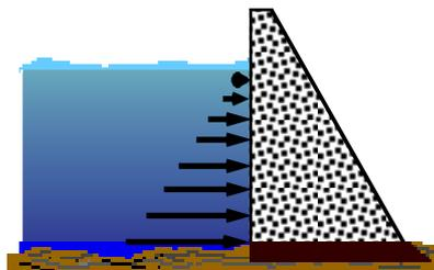
**Figure III.4** Dans un barrage hydraulique, la pression de l'eau s'applique sur toute la surface du mur. Cette pression est proportionnelle à la profondeur.
