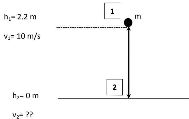
Puisque la résistance de l'air est négligée, le système sera considéré comme étant isolé, donc il y a une conservation de l'énergie mécanique du ballon en tout point du système,
