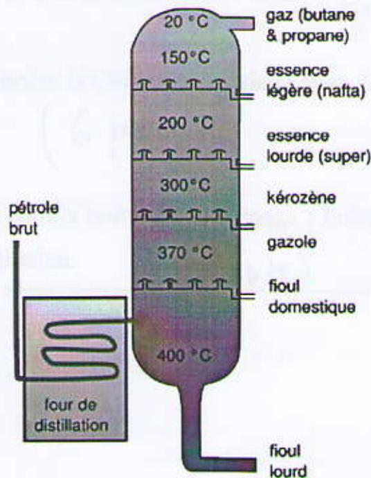
Fig. 1 Schéma d'une colonne de distillation
