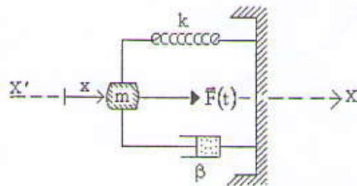
l'abscisse  $x = 0$ . L'entrée d'un courant électrique sinusoïdal  $i(t) = I_0 \sin \Omega t$  dans le haut parleur génère une force  $\vec{F}$  qui s'exerce, suivant l'axe  $X'X$ , sur son équipement mobile assimilé à une masse ponctuelle  $m$  comme illustré à la figure ci-dessus. La force  $\vec{F}$  est proportionnelle à l'intensité du courant électrique. Elle s'écrit :  $\vec{F}(t) = K i(t) \vec{i}$  où  $K$  est une constante et  $\vec{i}$  le vecteur unitaire de l'axe  $X'X$ .
