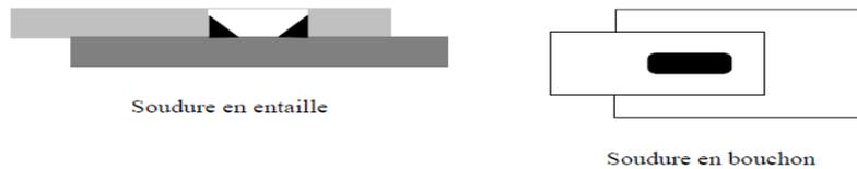
**Figure I.19 – Soudure en bouchon et soudures en entaille.**
