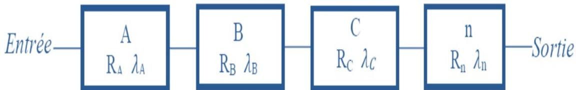
Figure III.1 Exemple de représentation d'un système en série
