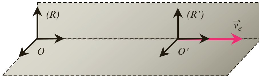
Figure 2.4 Le référentiel ( R' ) est en translation rectiligne uniforme par rapport au référentiel ( R ). Exemple : le tapis roulant. La vitesse, par rapport à la Terre, d'un point se déplaçant sur le tapis roulant est égale à la vitesse de ce point par rapport au tapis roulant plus la vitesse d'entraînement du tapis roulant.
