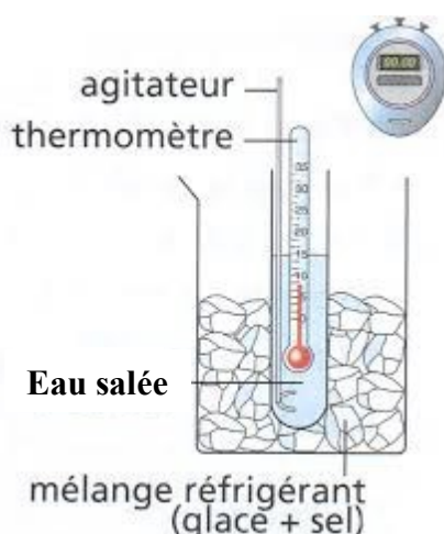
Figure 2 : Dispositif expérimental de solidification de l'eau salée.
