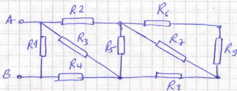
$R_6$  en série avec  $R_9$  — le tout parallèle avec  $R_7$
