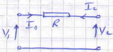
on observe que  $I_1 = -I_2$ . En outre  $V_1 = V_2 + RI_1 = V_2 - RI_2$ . Ces équations pourraient être présentées sous les formes
