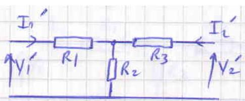
$$Y_{11}' = \frac{R_2 + R_3}{R_1 R_2 + R_1 R_3 + R_2 R_3}$$
