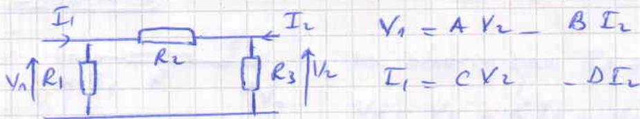
$$V_1 = A V_2 - B I_2$$
