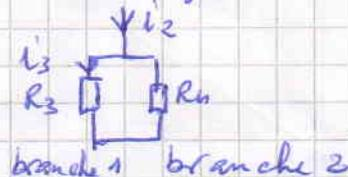
remplacer ensuite  $i_2$  obtenu de l'expression précédente  $\Rightarrow i_3 = \frac{R_4}{R_4 + R_3} \cdot \frac{R_5 \cdot i_1}{R_5 + R_2 + (R_3 \parallel R_4)}$
