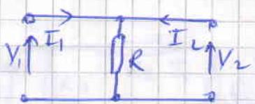
$V_1 = V_2$  et  $V_1 = R(I_1 + I_2)$ . Ce qui peut être écrit comme suit
