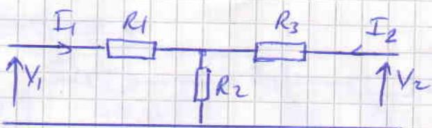
$$V_1 = A V_2 - B I_2$$
