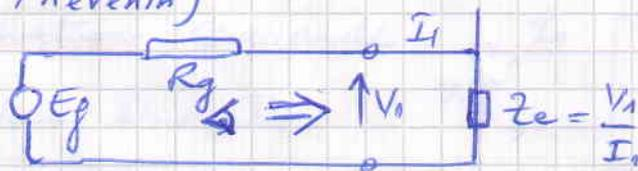
Vu du générateur, il est équivalent à une impédance  $Z_e = \frac{V_1}{I_1}$
