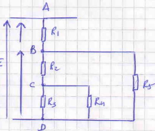
\* Branche BD =  $R_5$  en parallèle avec  $[R_2 + (R_3 // R_4)]$
