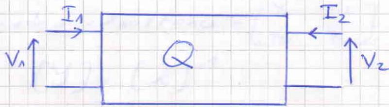
Le quadripôle communique par 2 bornes d'entrée et 2 bornes de sortie. Les sens choisis pour les courants sont conventionnels. Il existe 6 manières de représenter les 4 grandeurs ( $V_1, I_1, V_2, I_2$ ) deux à deux en fonction les unes des autres.
