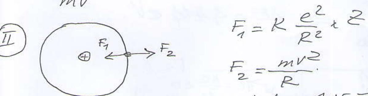
La stabilité de l'électron sur l'orbite de Rayon ( $R = 953 \text{ \AA}$ ) est assurée par l'égalité des 2 forces  $F_1 = F_2$
