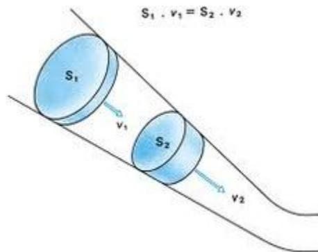
*Exemple : lors de l'étude d'un canal d'irrigation on mesure, dans la partie horizontale, ces différentes grandeurs : vitesse de l'eau est 1,2m/s ; la largeur du canal  $b=1,5m$  et la hauteur d'eau  $h=0,2m$ . un peu plus loin, dans une partie en pente, la hauteur n'est plus que de  $h=0,12m$ .*
