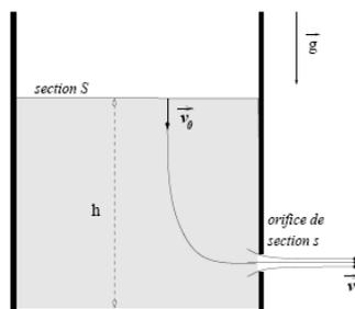
Exemple : un réservoir ouvert à l'air libre. un orifice B est pratiqué à 0,3m de la surface libre du liquide. le niveau du liquide est maintenu constant.
