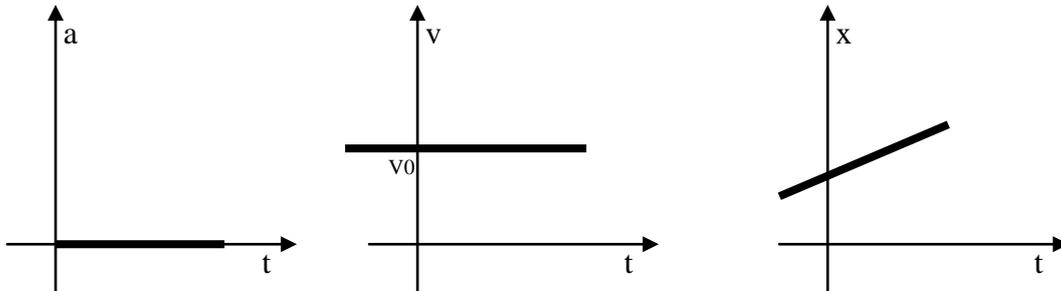
Figure 5 : diagrammes  $a(t)$ ,  $v(t)$  et  $x(t)$  dans le cas d'un mouvement rectiligne uniforme
