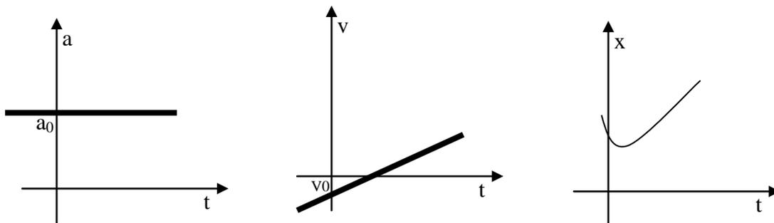
Figure 6 : diagrammes  $a(t)$ ,  $v(t)$  et  $x(t)$  dans le cas d'un mouvement rectiligne uniformément accéléré
