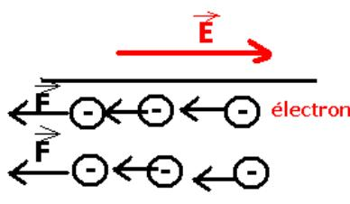
Le mouvement des électrons est perturbé par des obstacles comme les ions, les lacunes et les interstitiels. Ces obstacles ralentissent le mouvement des particules chargées et l'intensité du courant diminue. Ce phénomène est caractérisé par une constante  $R$  qu'on appelle « résistance électrique ».
