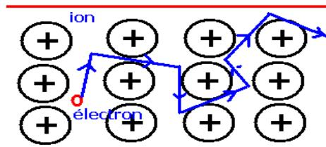
Si  $\vec{E} = \vec{0}$ , le déplacement moyen des électrons est nul. La vitesse moyenne des électrons est aussi nulle ( $\bar{v} = 0 \text{ m/s}$ ).
