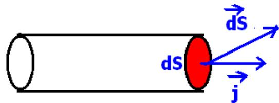
Le courant dans le fil est donc le flux à travers la section du fil de la densité du courant.
