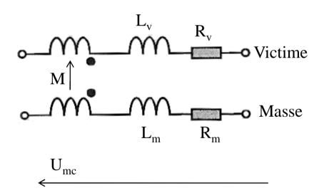
Rappel: Le rapport de la tension (ou courant) du mode commun mesurée aux extrémités du conducteur de masse en présence du câble signal sur la même tension (ou courant) en absence du câble signal.
