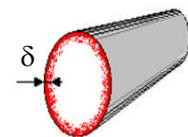
L'épaisseur de peau diminue avec la racine carrée de la fréquence, avec la conductivité et la perméabilité.
