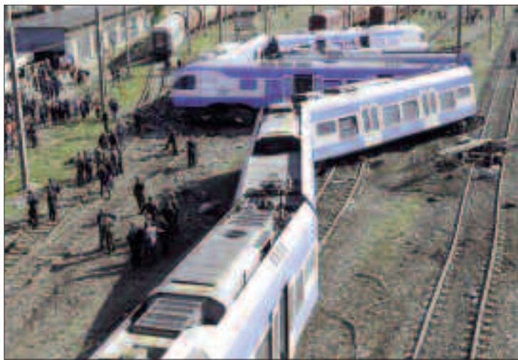
Le train est sorti de sa voie et a percuté des poteaux caténaires.
