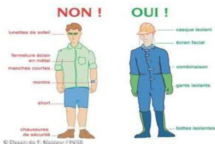
Figure VI.13 : La tenue réglementaire d'un opérateur électrique
