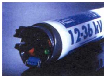
Figure VII.15 : Vérificateur d'absence de tension pour HT A
