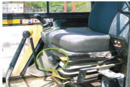
Figure IX.9 : Réduction des vibrations par réglage du siège
