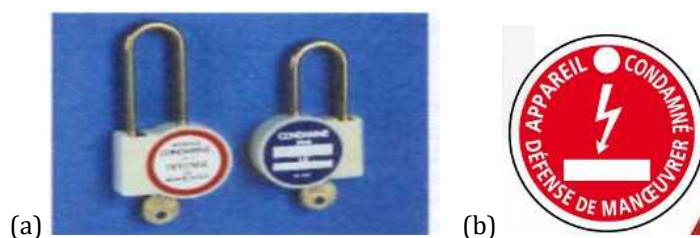
Figure VII.13 : Condamnation par cadenas (a) et pancarte (b)
