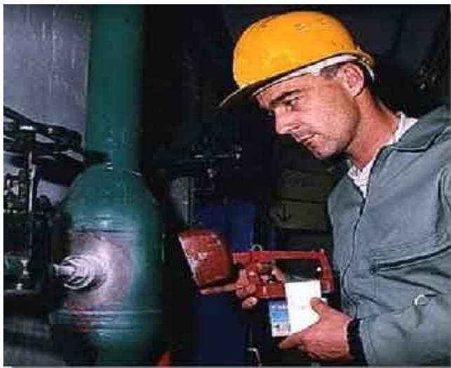
*Utilisation du contrôle par ressuage fluorescent pour la vérification des fuites dans une installation industrielle*
