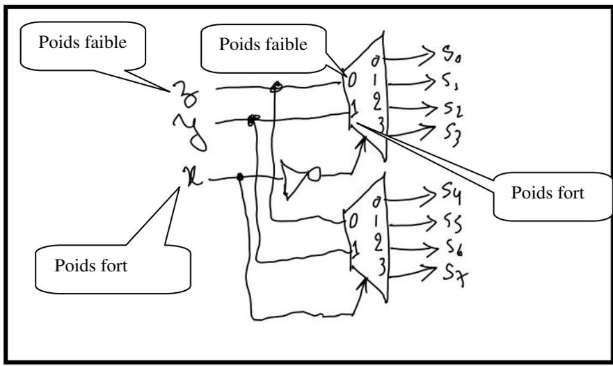
**Q15 – MUX (1 point):** Donnez l'équation de sortie des circuits suivants :
