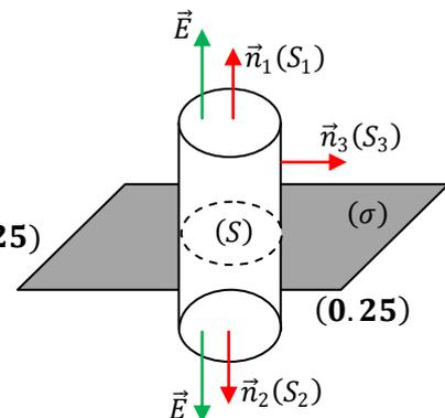
$$\Phi = \oiint_{(S_G)} \vec{E} \cdot \vec{dS} = \iint_{(S_1)} \vec{E} \cdot \vec{dS} + \iint_{(S_1)} \vec{E} \cdot \vec{dS} + \iint_{(S_1)} \vec{E} \cdot \vec{dS} = \iint_{(S_1)} \vec{E} \cdot \vec{n}_1 dS + \iint_{(S_1)} \vec{E} \cdot \vec{n}_2 dS + \iint_{(S_1)} \vec{E} \cdot \vec{n}_3 dS \quad (0.25)$$
