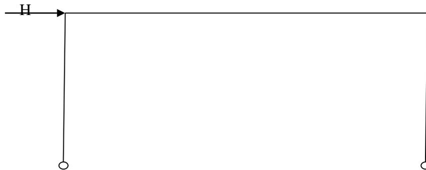
Figure 19: schéma statique du portique chargé horizontalement
