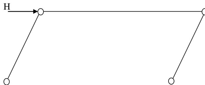
Figure 20 : Mécanisme de ruine pour cause de système hypostatique (ici les liaisons rigides poteaux poutres ont été supprimées)
