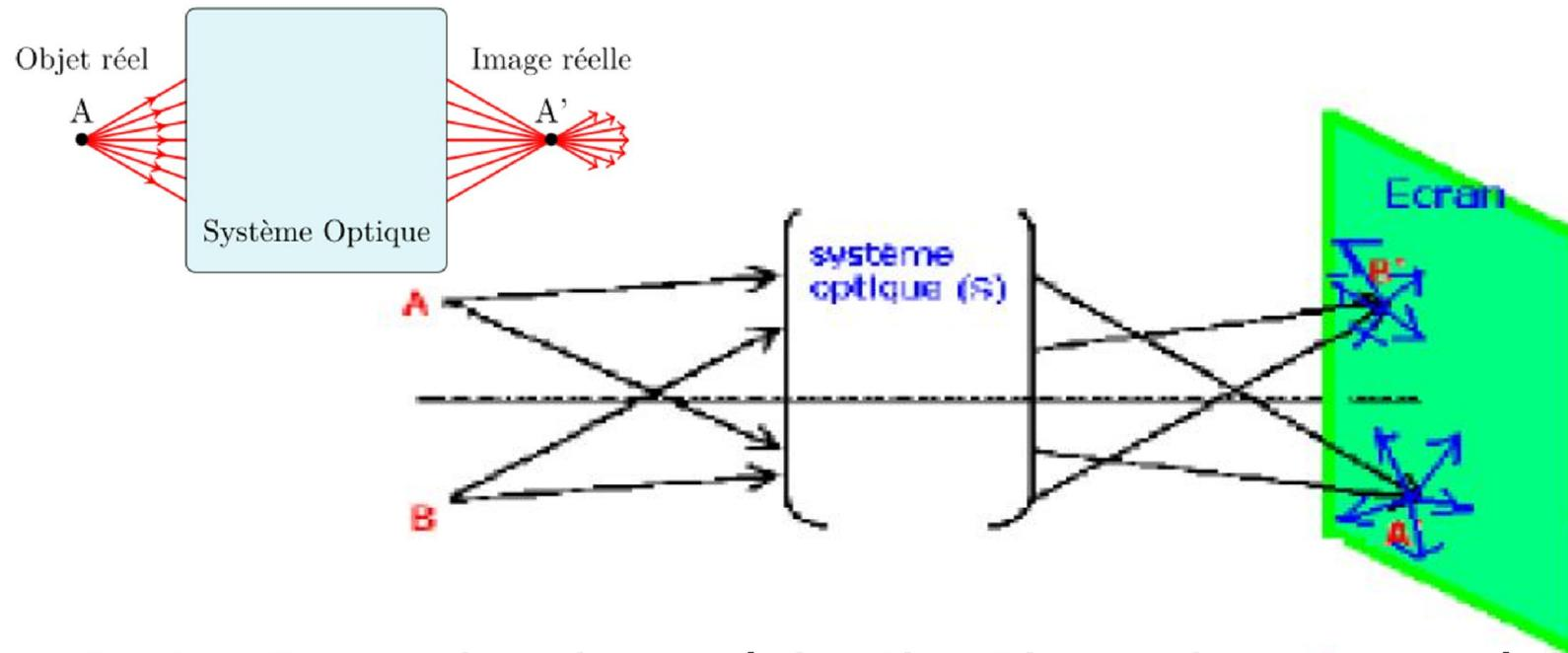
**Ici  $A$  et  $B$  sont des objets réels,  $A'$  et  $B'$  sont des images réelles.**
