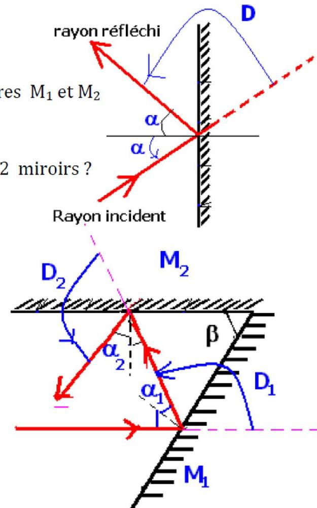
**Exemple 2 :** Soient 2 miroirs plans non perpendiculaires  $M_1$  et  $M_2$ . Soit un point lumineux  $A$  (figure). Construire géométriquement les positions des images de  $A$  données par ces miroirs.
