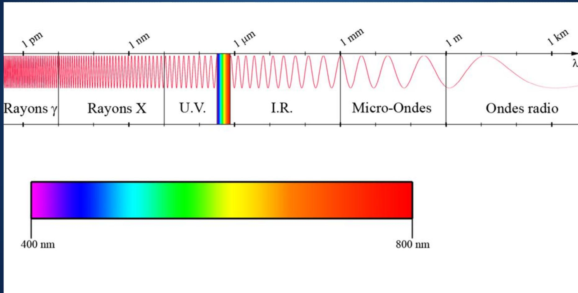
L'onde lumineuse est caractérisée par une fréquence ( $\nu$ ), une longueur d'onde ( $\lambda$ ), une vitesse de propagation ou célérité (la vitesse de la lumière  $c$ ), telle que:
