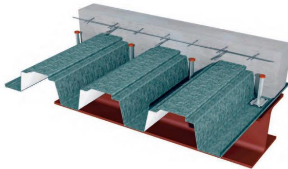
Figure 2 : Plancher mixte collaborant (Acier-Béton)
