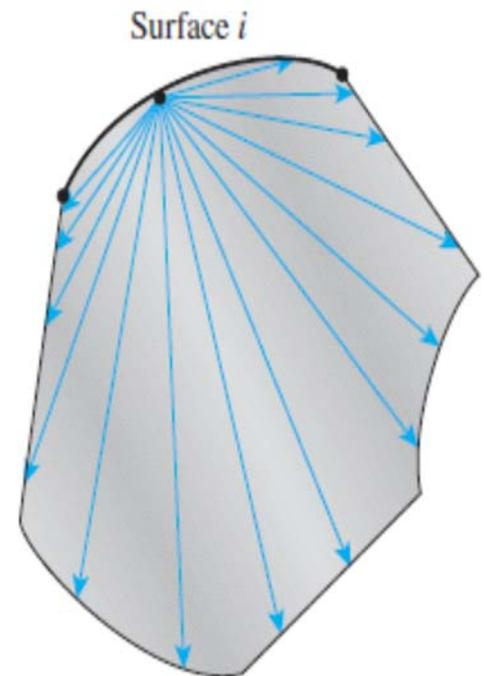
Fig. IV.15. Rayonnement dans une cavité fermée
