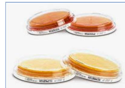
**Neutralisant de désinfectant** : Les milieux sont additionnés d'un ou de plusieurs neutralisants actifs sur les **produits détergent-désinfectants**.
