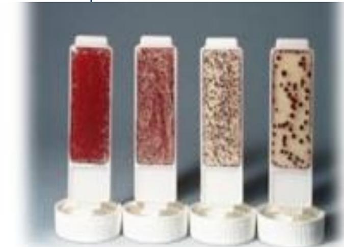
Ce test est utilisé pour le contrôle de l'efficacité des procédures de désinfections des surfaces et du matériel, de l'hygiène des mains, l'hygiène des textiles et de la qualité microbiologique d'échantillon liquide par immersion.
