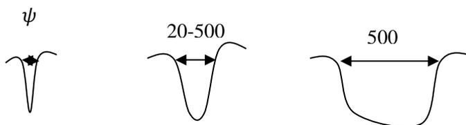
Les isothermes du type IV et V s'obtiennent avec des gaz facilement liquéfiables et sur des solides dont  $\phi_p/20\text{\AA} < \phi_p < 500\text{\AA}$  aux pressions élevées  $0,4 < \frac{P}{P_0} < 0,9$ , le chemin de la désorption ne coïncide pas avec celui de l'adsorption. C'est le phénomène **d'hystérésis**.
