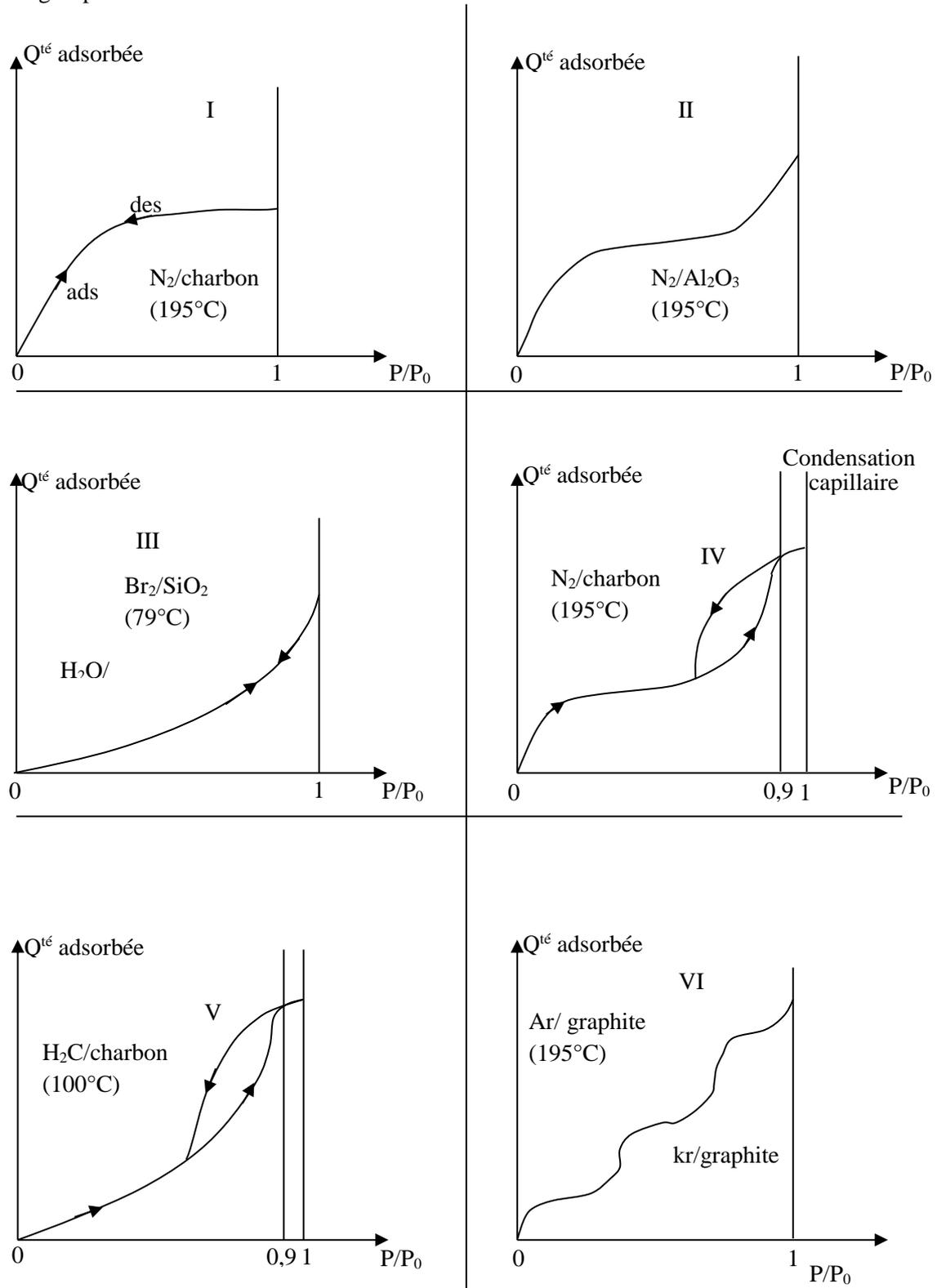
**Isotherme du type I** : représente la formation d'une couche monomoléculaire adsorbée sur un solide non poreux ou microporeux ( $\phi_p < 20\text{\AA}$ )  $\phi_p$  : diamètre des pores.
