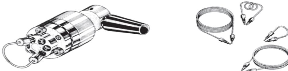
**Figure 34:** Vanne d'injection pour CLHP et boucles assorties.
