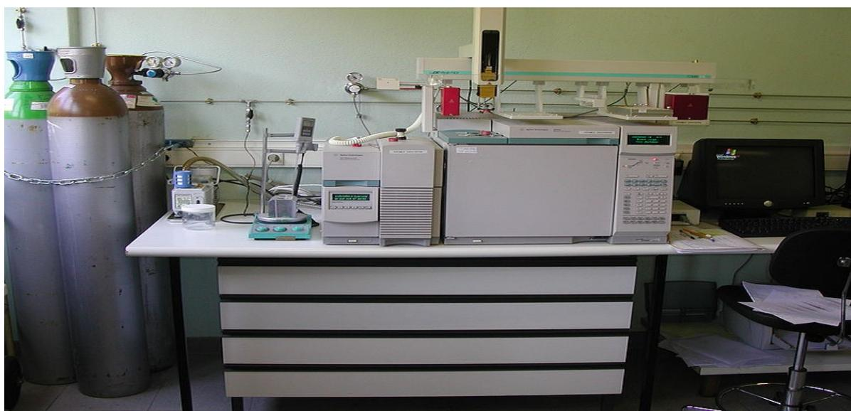
**Figure 27:** (a) et (b) schéma et photo d'une installation de CPG
